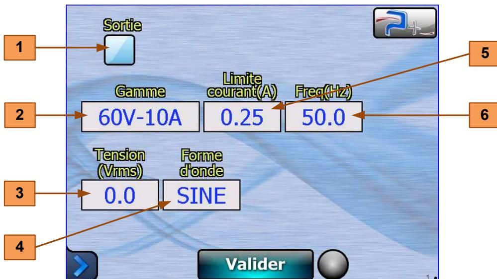
La case à cocher **1** permet de commander le contacteur de sortie de la source :
