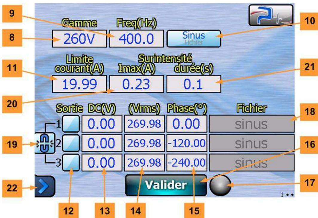
Le bouton **22** situé dans le coin inférieur gauche de l'écran donne accès au menu principal et aux autres écrans du logiciel. Le changement d'écran peut également être opéré par un balayage horizontal sur l'écran avec un doigt ou un stylet.
