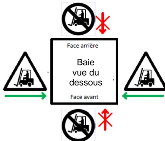
Le socle de la baie est disposé à 140 mm au-dessus du sol. Les fourches doivent être introduites par les faces latérales, conformément au marquage réalisé
