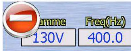
Les paramètres de la connexion sont modifiables par écran tactile uniquement si l'on se trouve en mode « local ».
