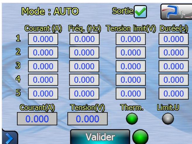
En mode AUTO, sont programmables jusqu'à 5 pas en amplitude, en fréquence et en durée.
