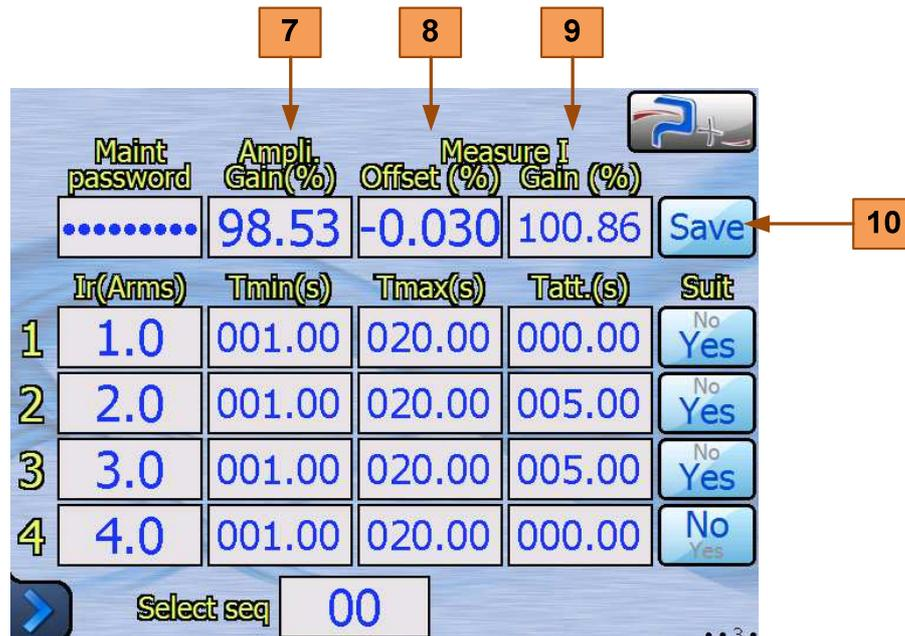
La zone de saisie **7** règle le gain de l'amplificateur : c'est le coefficient de correction entre la consigne et le courant réellement généré par la source. Ce gain est réglable entre 90% et 110%. Le réglage du gain permet d'obtenir une précision de génération meilleure que 1% de 7 ARMS à 200 ARMS.
