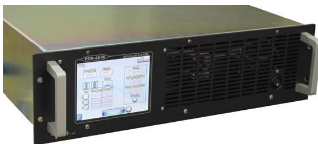
Exemple de face avant d'un tiroir de commande avec sa carte à écran tactile
