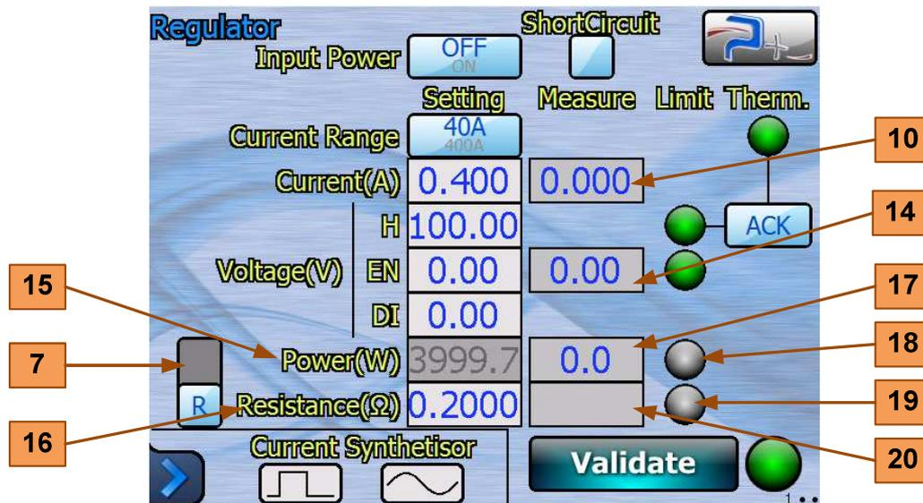
La zone de saisie « Résistance( $\Omega$ ) » **16** est programmable (elle n'est plus grisée). Elle permet de programmer la résistance de 0 à 2000 ohms.
