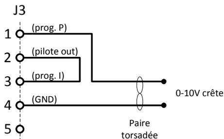
La liaison entre point 2 et point 3 permet la programmation du courant par l'écran tactile de la charge.
