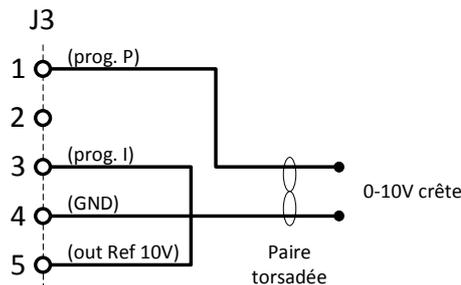
La liaison entre point 3 et point 5 fixe le courant au maximum de la gamme sélectionnée. Il n'est alors plus programmable.
