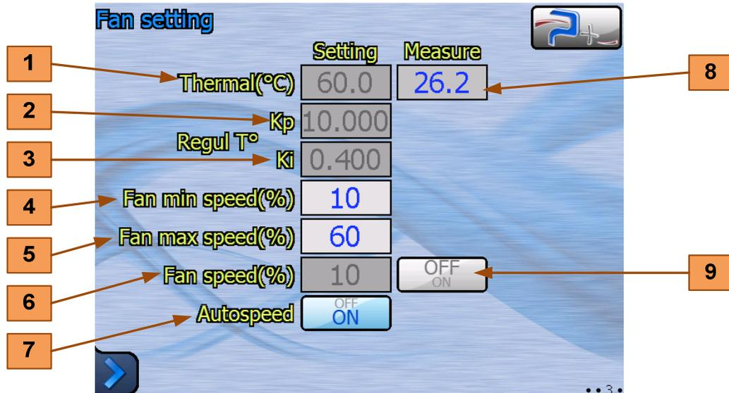
Cette charge gère la vitesse des ventilateurs, de 0% à 100%, en fonction de la température des différents éléments de puissance.
