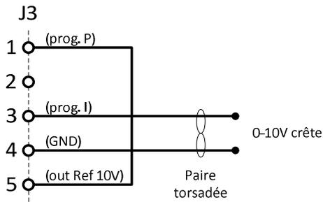
La liaison entre point 1 et point 5, tension 10V, permet d'utiliser la pleine échelle de programmation en puissance
