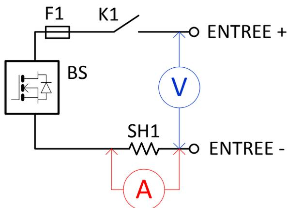
Le contacteur K1 permet la mise en / hors service de la charge. Celle-ci mesure en permanence la tension sur son entrée et le courant à travers un shunt. Les blocs de transistors BS régulent la charge de façon linéaire en fonction du mode de couplage :
