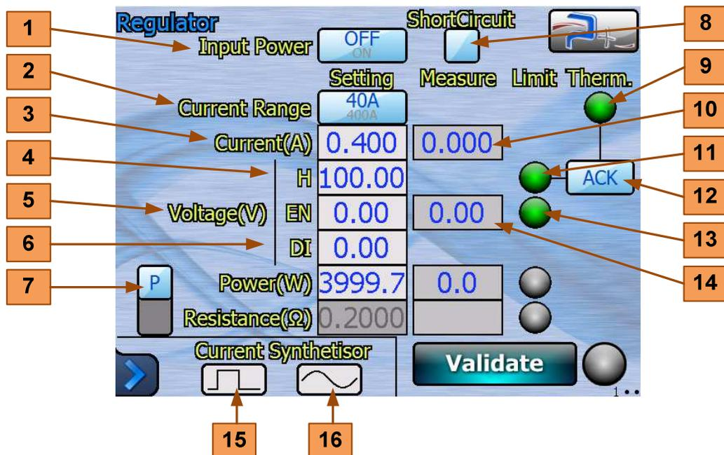
Le bouton « Input Power » **1** permet de fermer (texte ON en bleu) ou d'ouvrir (texte OFF en bleu) le relais d'entrée de la charge. Au démarrage, le relais est ouvert.
