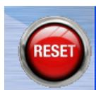
Après enregistrement, cette nouvelle configuration ne sera prise en compte que lors d'un redémarrage de la carte de contrôle du banc. Celui-ci peut être forcé en cliquant sur cette icône qui apparaît en bas à droite sur l'écran.
