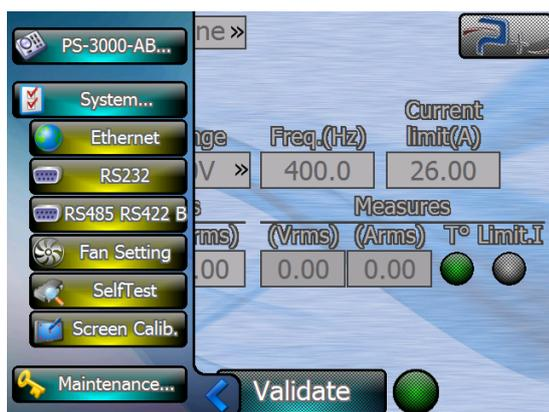
D'autres écrans permettent de paramétrer les liaisons de communication ou la gestion de la ventilation à vitesse variable.
